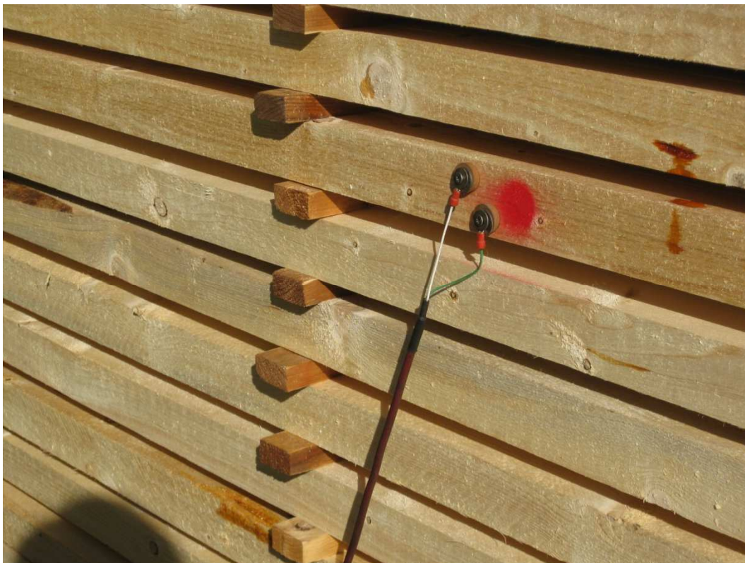
Überprüfung des Trocknungsgrades mittels elektronischer Holzfeuchtemessung
