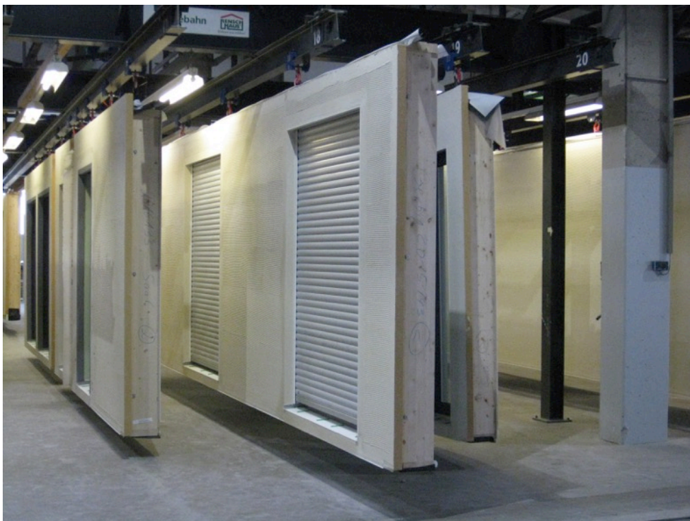
Vorgeputzte Außenwandelemente warten auf den Abtransport
